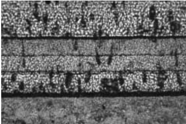
Abb. 2: Trennlinien durch Temperaturschwankungen
